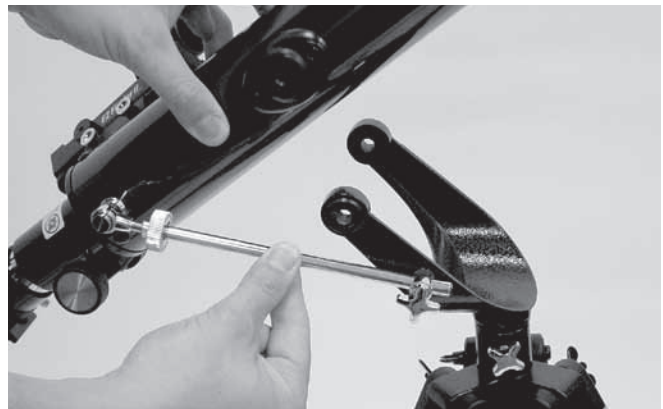
Figure 4. Installation du tube optique dans la « fourche » de la monture azimutale
