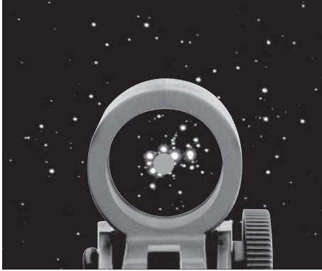
Figure 7. Le chercheur EZ Finder II superpose un petit point rouge sur le ciel, indiquant l'endroit où le télescope est pointé.
