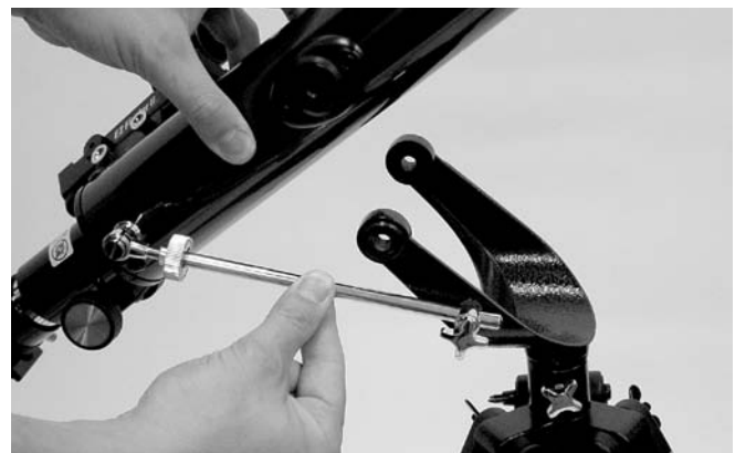
Figura 4. Instalación del tubo óptico en la montura altacimital de horquilla
