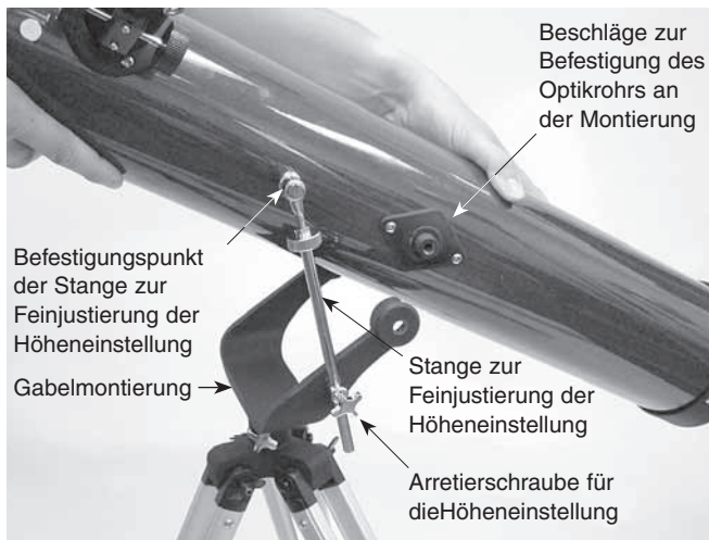
Abbildung 2. Installieren des Optikrohrs auf der azimutalen Gabelmontierung
