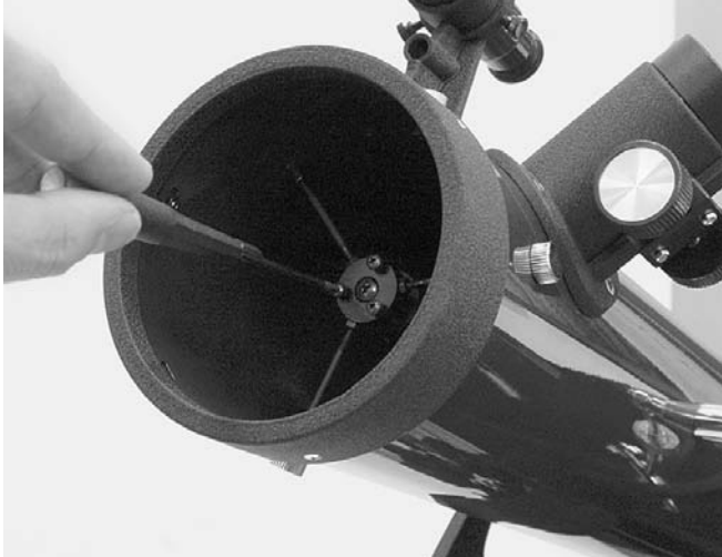
Figura 8. Ajuste la inclinación del espejo secundario aflojando o apretando los tres tornillos de ajuste de alineación con un destornillador de estrella pequeño.
