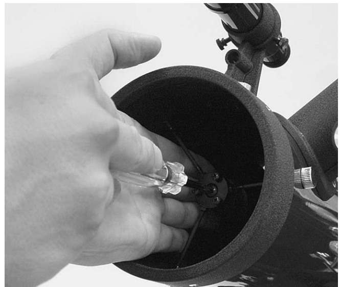
Figura 7. Para centrar el espejo secundario debajo del enfocador, sujete el secundario en su lugar con los dedos mientras ajusta el tornillo primario con un destornillador de estrella. No toque la superficie del espejo.
