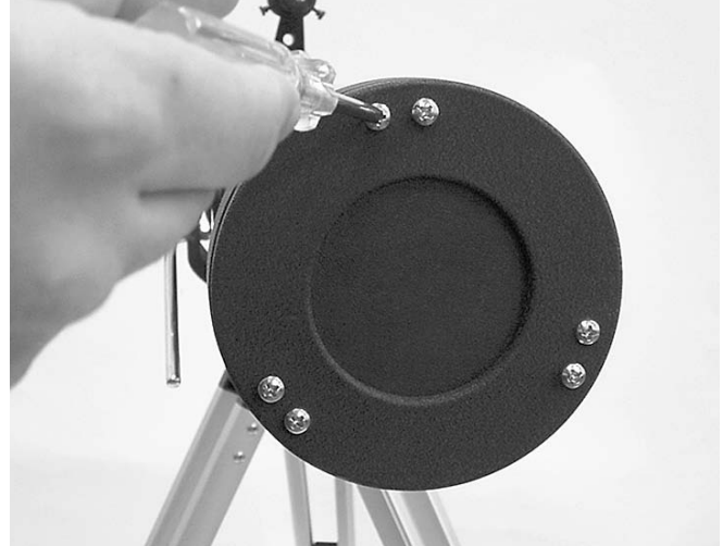
Figura 9. Afloje una vuelta completa un tornillo de la parte posterior del tubo óptico y apriete el otro tornillo "del conjunto" hasta que quede apretado para ajustar el espejo primario.
