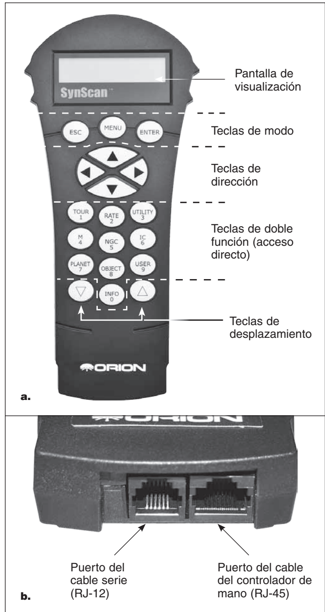
Figura 11. a) Controlador de mano SynScan GoTo, b) Cable del controlador de mano y puertos de cable serie en el extremo inferior del controlador
