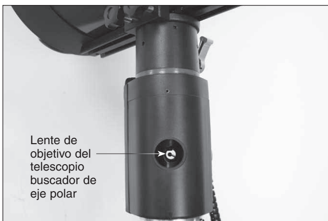
Figura 10. El tubo óptico debe girar alrededor del eje de Dec. hasta que tenga una visión clara a lo largo del eje de A. R. con el telescopio buscador de eje polar.
