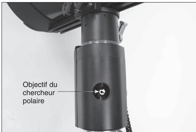
Figure 10. Le tube optique doit être tourné autour de l'axe de déclinaison jusqu'à ce que vous ayez une vue dégagée le long de l'axe d'ascension droite avec le chercheur polaire.
