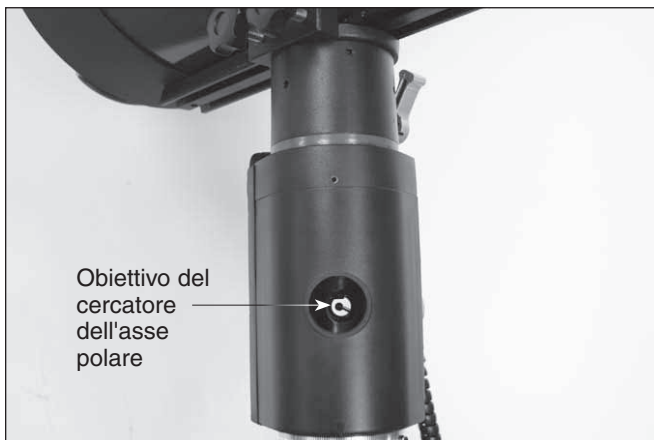
Figura 10. Il tubo ottico deve essere ruotato attorno all'asse di declinazione fino a vedere un'immagine nitida sull'asse di ascensione retta con il cercatore dell'asse polare.
