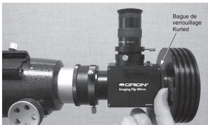
Figure 4. Utilisez la bague de verrouillage moletée pour sécuriser l'orientation de l'appareil.
