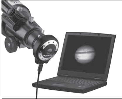
Figura 1. Para utilizar la SSSSI-IV, se necesitan un telescopio, la montura y el ordenador.
