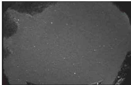
Abbildung 14. Bei einer Brennweite von 3,1 mm ist das Sichtfeld kleiner (ca. 90°-Bildwinkel). Das Bild ist größer und hochauflösender.
