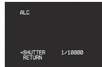
Abbildung 6. Das Menü „ALC (ALC)“ zum Einstellen der Verschlusszeit.
