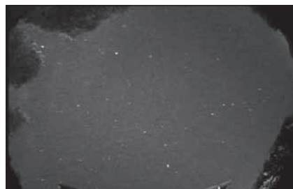
Figure 14. À 3,1 mm, on voit moins de ciel (~ angle de vue de 90 degrés). L'image est plus grande et a une plus haute résolution de détail.
