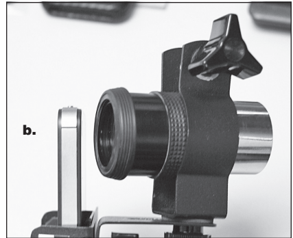
Abbildung 5. Die Linse des Okulars muss sich gegenüber dem Smartphone in der Waagerechten (a) befinden und darf nicht schräg (b) sitzen.
