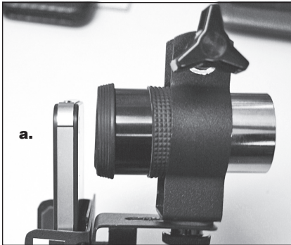
Abbildung 5. Die Linse des Okulars muss sich gegenüber dem Smartphone in der Waagerechten (a) befinden und darf nicht schräg (b) sitzen.
