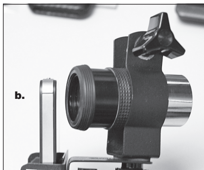
Figure 5. La lentille de l'oculaire doit être parallèle au smartphone (a), et non inclinée comme il apparaît sur (b).
