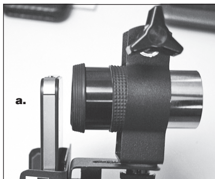
Figure 5. La lentille de l'oculaire doit être parallèle au smartphone (a), et non inclinée comme il apparaît sur (b).
