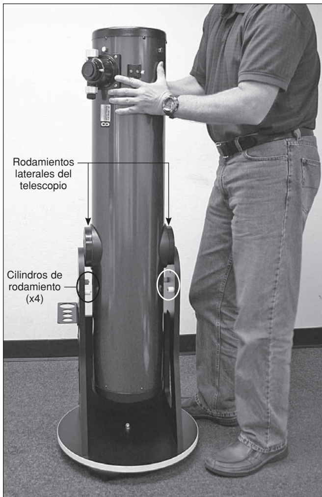
Figura 8. Coloque suavemente el telescopio en la base dejando descansar los rodamientos laterales del telescopio sobre los cilindros de rodamiento.
