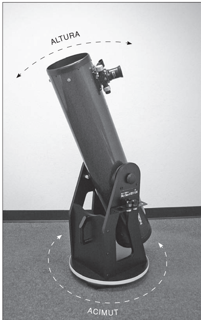
Figura 13. Los dobsonianos XT PLUS son telescopios prácticos que tienen dos ejes de movimiento: altura (arriba/abajo) y acimut (izquierda/derecha). Sujete la parte delantera del telescopio y muévelo hasta el punto deseado en el cielo.
