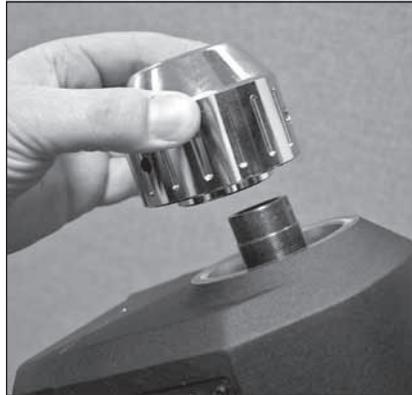
**Abbildung 5.** Lockern Sie die drei Stellschrauben am Sockel der Gegengewichtsstange.
