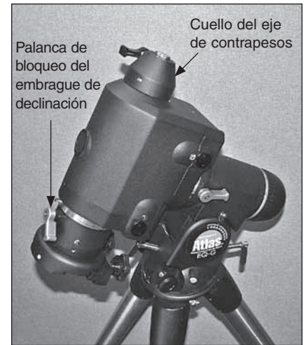
Figura 2. Gire la cabeza EQ boca abajo antes de retirar el cuello del eje de contrapesos.
