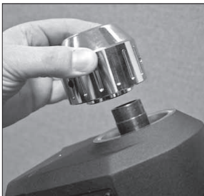
Figure 5. Desserrez les trois vis de fixation de la bague de la barre de contrepoids.
