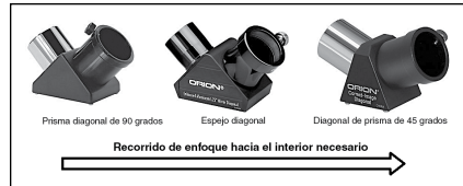
Figura 2.2. Si necesita un mayor recorrido de enfoque hacia el interior, es posible que necesite una diagonal de prisma de 90 grados. Una diagonal de prisma de 45 grados requiere más enfoque hacia el interior que cualquier otra diagonal.
