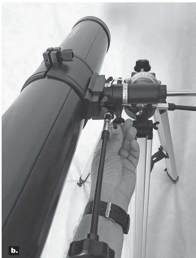
**Abbildung 20.** Ausbalancieren des Teleskops über die **a)** RA- und **b)** Dek-Achse.
