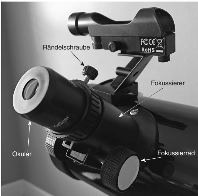
**Abbildung 17.** Im Fokussierer installiertes Okular
