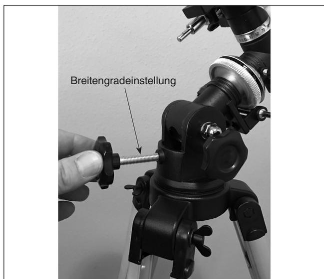
**Abbildung 8.** Schrauben Sie dann die Breitengradeinstellung ein.
