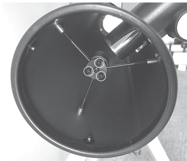
**Abbildung 23.** Stellen Sie mit einem Kreuzschlitz-Schraubendreher die Neigung des Sekundärspiegels durch Justieren der drei Stellschrauben für die Sekundärspiegelausrichtung ein.
