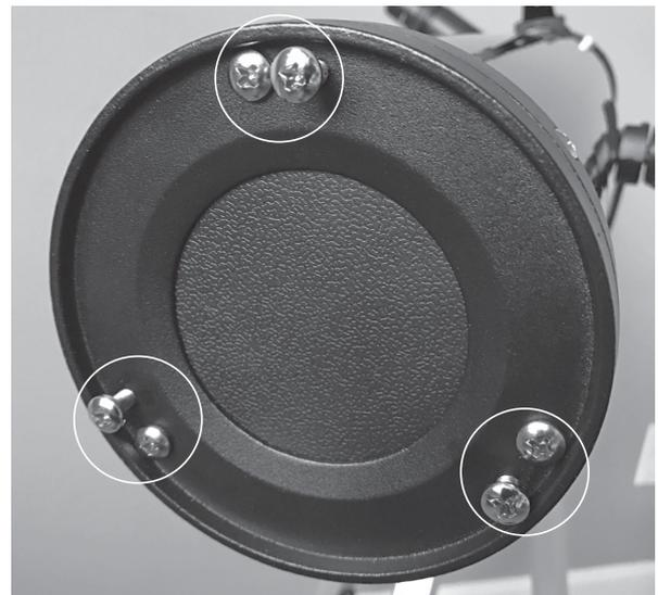
**Abbildung 24.** Die Neigung des Primärspiegels wird mit den drei Schraubenpaaren am hinteren Ende des Optikrohrs eingestellt.
