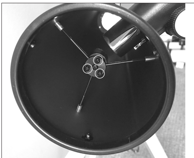
Figura 23. Ajuste la inclinación del espejo secundario aflojando o apretando los tres tornillos de ajuste de alineación con un destornillador Phillips.
