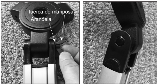
Figura 3. a) Acople las tres patas del trípode a la plataforma de la montura, b) asegurándose de que la cabeza hexagonal del perno se apoya sobre el hueco hexagonal de la pata del trípode.
