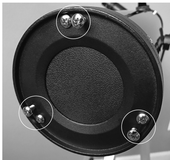
Figura 24. Alinee el espejo primario ajustando los tres pares de tornillos de "empujar y tirar" del extremo posterior del tubo óptico..
