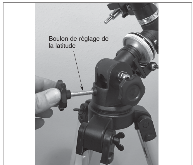
Figure 8. Vissez le boulon de réglage de la latitude.
