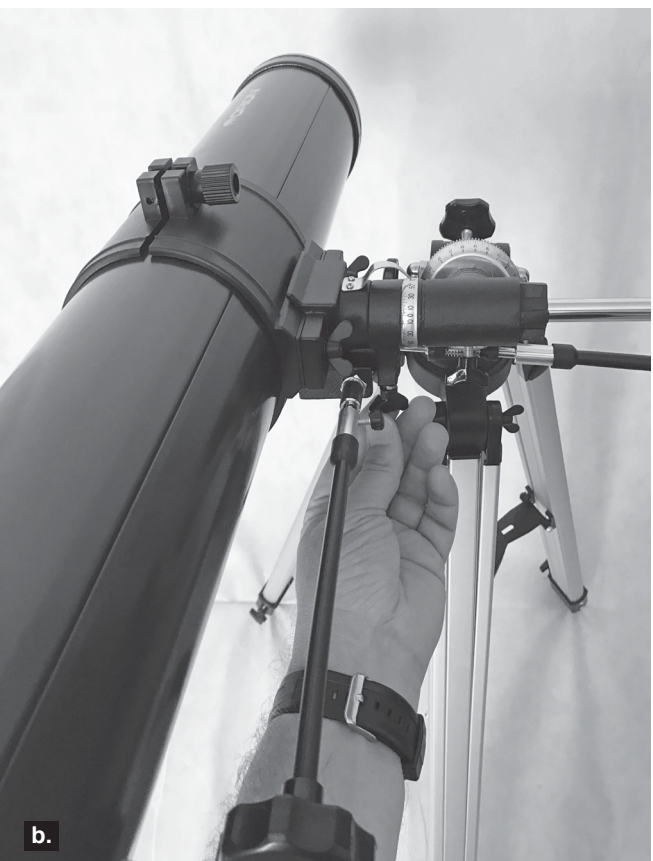
Figure 20. Équilibrage du télescope sur les axes a) de l'ascension droite et b) de la déclinaison.
