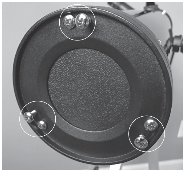
Figure 24. Alignement du miroir primaire par ajustement des trois paires de vis "tirer-pousser" à l'extrémité arrière du tube optique.
