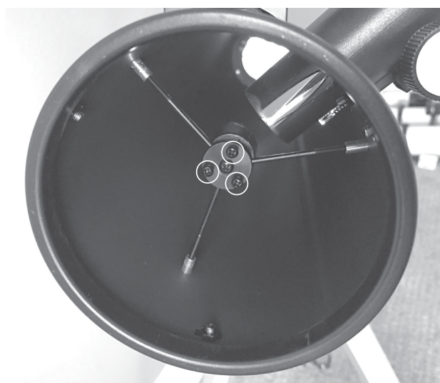
Figure 23. Ajustement de l'inclinaison du miroir secondaire par ajustement des trois vis d'alignement à l'aide d'un tournevis cruciforme.
