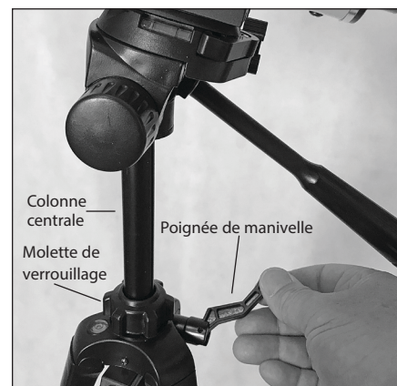
Figure 11. Utilisez la poignée de la manivelle pour déplacer la colonne centrale adaptée vers le haut ou le bas, en vous assurant de desserrer d'abord un peu la molette de verrouillage de la colonne centrale.
